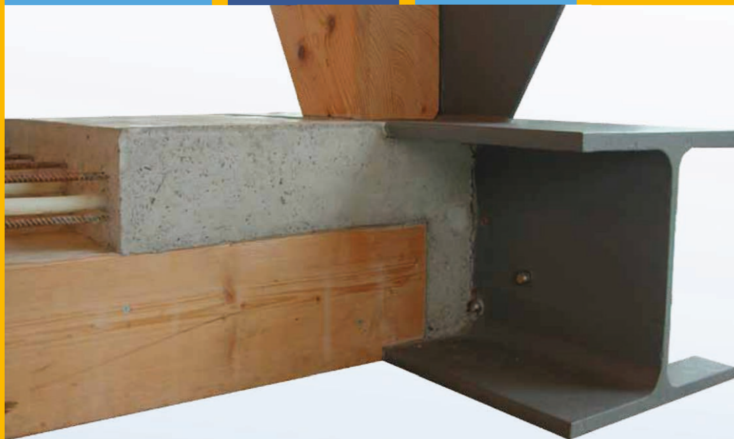
Hybride bouwwijze met hout/beton vloeren als thermische buffer
