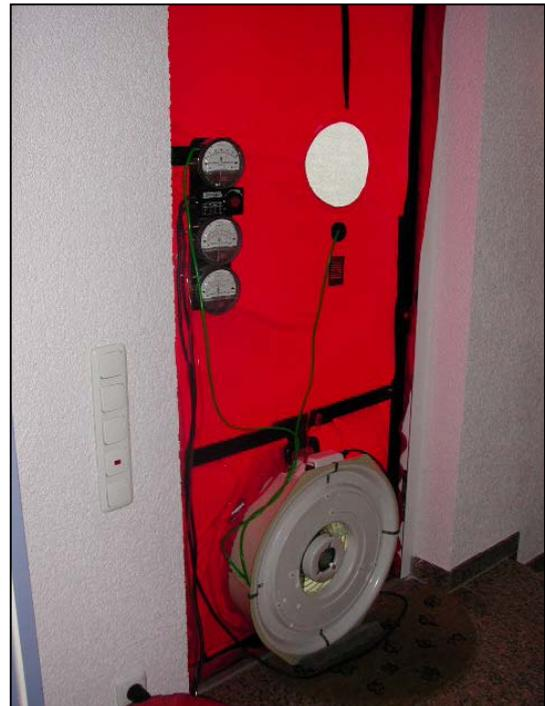
Blower-Door-Messeinrichtung mit Gebläse im eingebauten Zustand
