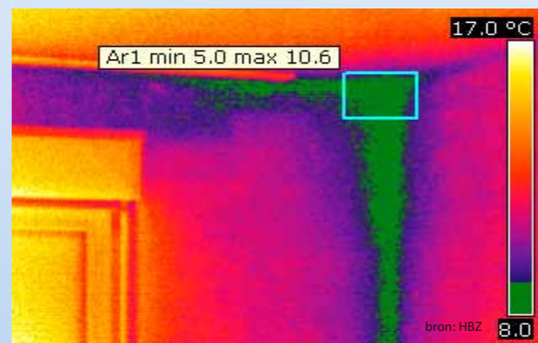
Geometrische warmtebrug waarbij de temperatuur onder de condensatiegrens zakt
