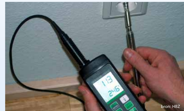
Stroomsnelheid van indringende koude lucht bij een onderdrukmeting
