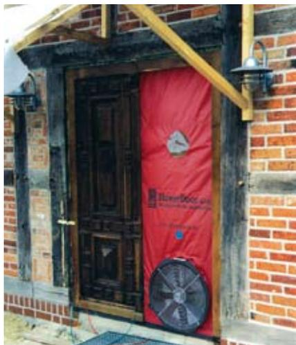
Abb. 07. Blower-Door-Test bei einem Altbau
