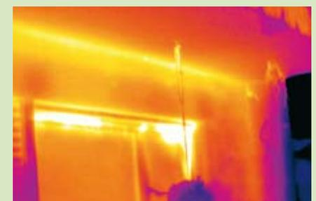
Abb. 31. Thermografie von außen, nach den Dämmmaßnahmen
