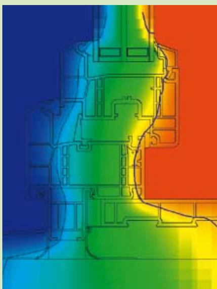
Abb. 25. Isothermenverlauf in einem guten Fenster
