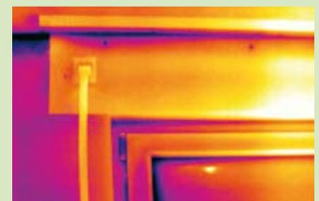
Abb. 32. Thermografie von innen, nach den Dämmmaßnahmen
